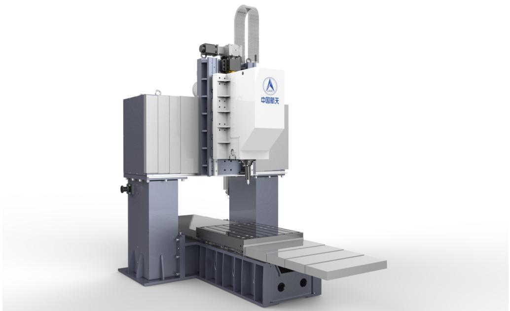
这款中型二维搅拌摩擦焊设备除了以上的设备特点，其中在设备的结构当中，尤其需要采用蜗轮蜗杆传动方式，传动刚性好的C轴。此外还配备大扭矩主轴，高刚性床身，并可扩展恒压力控制、激光焊缝寻踪、起点自动对、焊接参数与提取功能。这些摩擦焊的特点对这款设备的优势更是添加风采，也成为制造业中用途较为广的摩擦焊设备之一。
